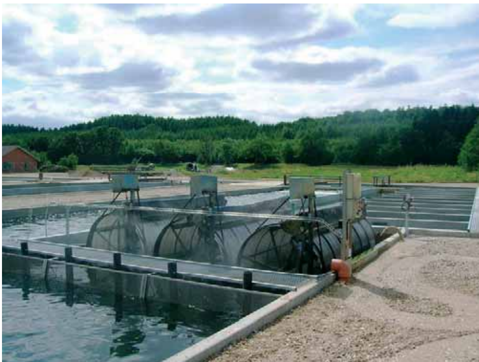
Figur 18. Mikrosigter på Løjstrup modeldambrug type 3. Mikrosigterne er placeret lige før biofilterenhederne. Foto: Lisbeth J. Plesner.
